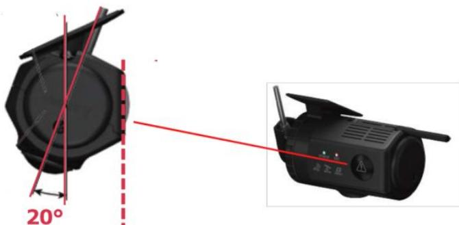
ブラケットに本体を装着し、ランプ面が地面と垂直になるように調整する
